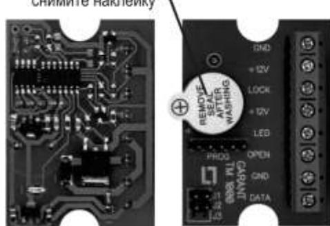
После удаление всех пользовательских ключей свето-диод гаснет, а контроллер выходит из режима про-граммирования.
